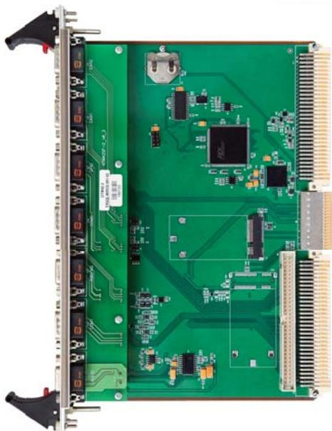
Модуль **OTM43V** предназначен для подключения к интерфейсам, выходящим на тыльную сторону процессорного модуля O43V через стандартные соединители на передней панели.
