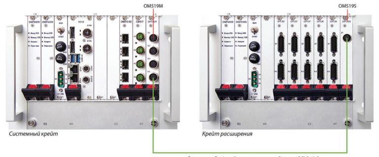
подключение до 4 крейтов расширения CompactPCI Serial
