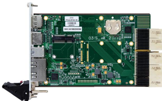
Модуль **O31S.B** представляет собой PC-совместимый модуль процессора и предназначен для использования в качестве основного центрального вычислительного и обрабатывающего устройства в автоматизированных системах управления.
