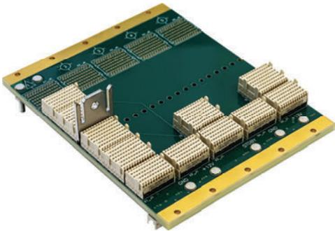
Крейты/корпуса оснащаются **объединительными платами CompactPCI Serial** различных модификаций производства OCATEK, выполненными в соответствии со стандартом CompactPCI Serial (PICMG CPCI-S.0).
