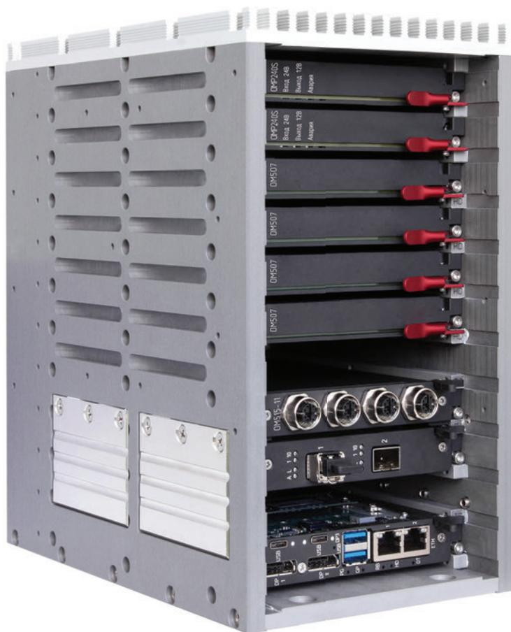
На фотографии приведен пример построения системы CompactPCI Serial в корпусе **кондуктивного исполнения**.
